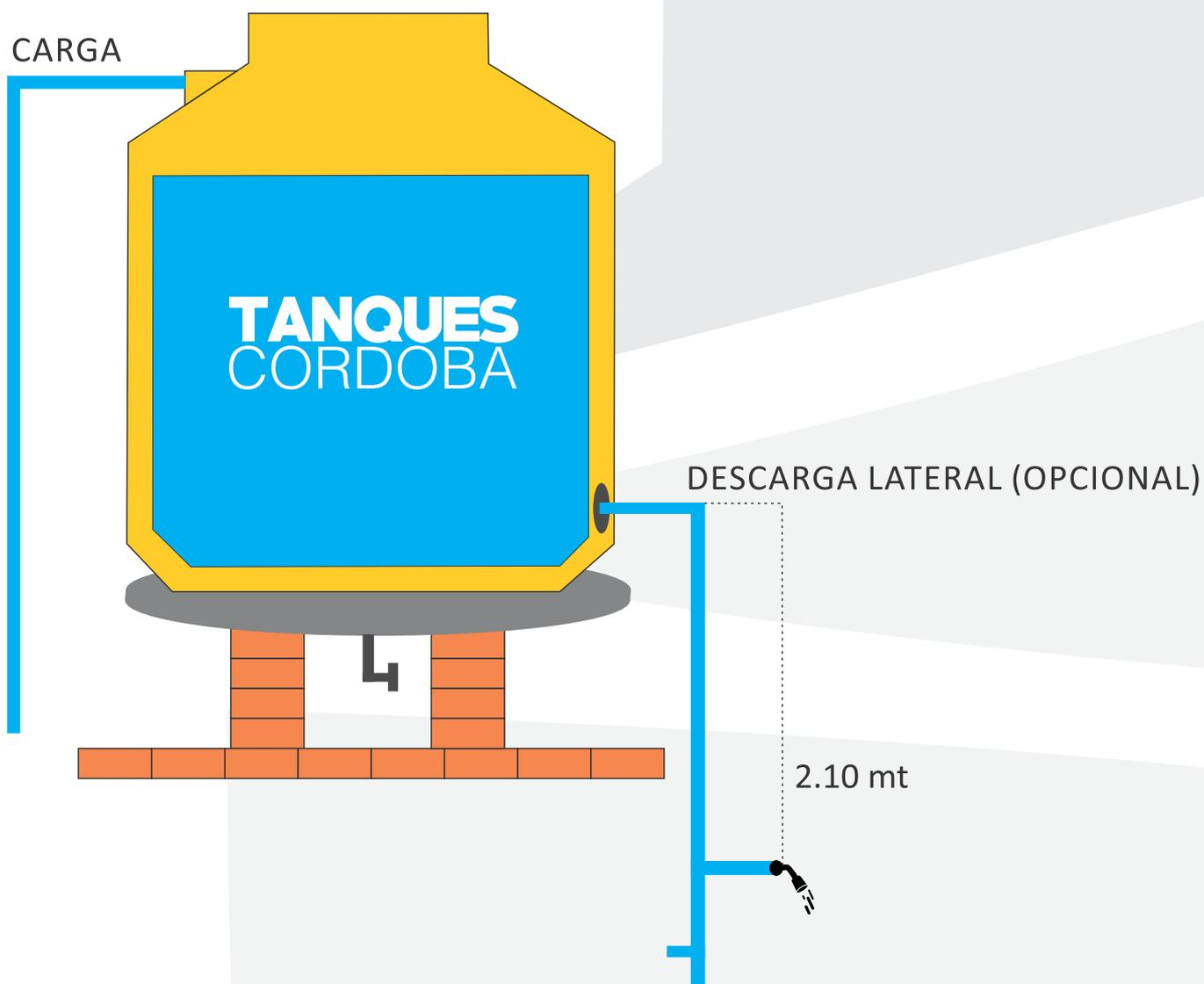
La estructura de soporte debe ser base plana nivelada firme. Abarca la totalidad del asiento del tanque.
